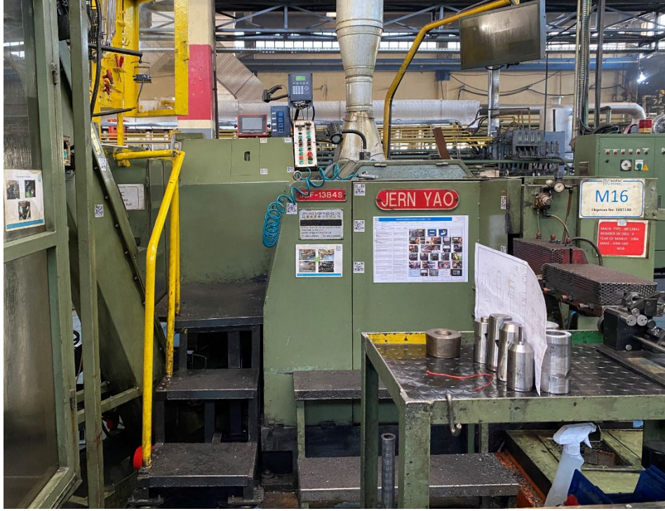
Şekil 4.11: Üretim doğrulama çalışmalarının yürütüldüğü soğuk şekillendirme makinası
